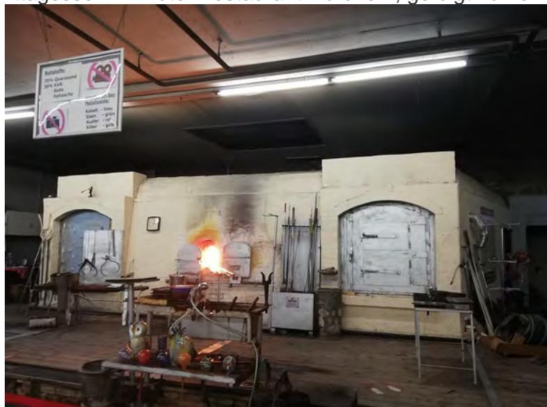
Glasschmelzofen (Mitte) und Kühlkammern
